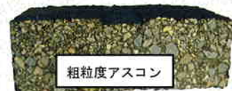
10cm厚さの供試体による ホイールトラッキング試験
